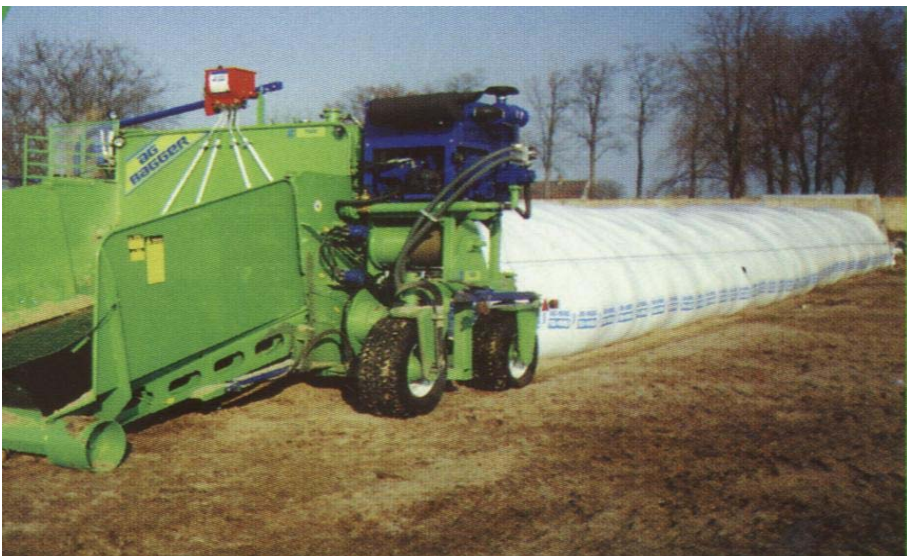
Rys. 1. Prasa pakująca ziarno kukurydzy w rękaw foliowy (AG-BAG) Fig. 1. Machine packing the maize grain into foil sleeve (AG-BAG)
