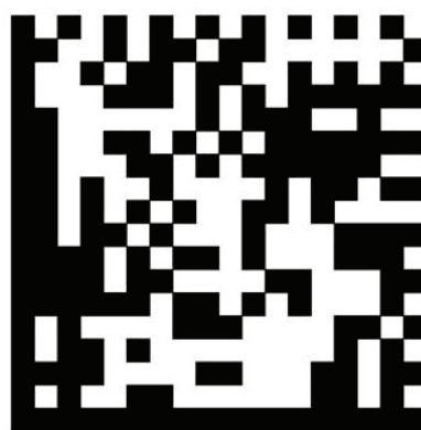
Rys. 2. DataMatrix zawierający krótki tekst Fig. 2. A DataMatrix symbol encoding a short text
