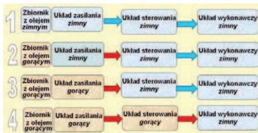
Rys. 1. Cztery przypadki warunków uruchomienia układów hydraulicznych w niskich temperaturach otoczenia
