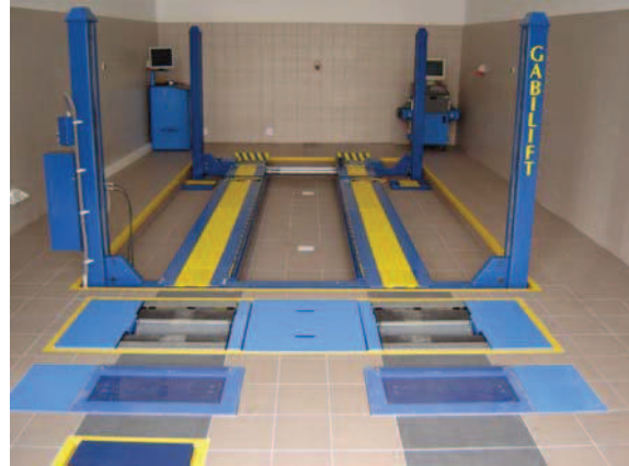
Rys. 3. Linia osobowa firmy Unimetal (urządzenia wbudowane w posadzkę i podnośnik 4-kolumnowy)
