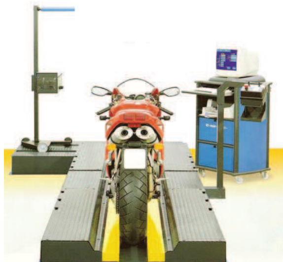
Rys. 13. Widok linii diagnostycznej do badania pojazdów jednośladowych firmy Giuliano
