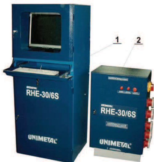
Rys. 10. Centralna jednostka sterująca mobilnej linii diagnostycznej firmy Unimetal: 1 – szafka z komputerem, monitorem i drukarką, 2 – szafka elektryczna
