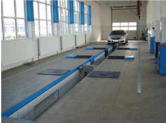
Rys. 16. Widok uniwersalnej linii diagnostycznej Uniline-5000 firmy Unimetal do badania pojazdów o dmc do i powyżej 3,5 t
