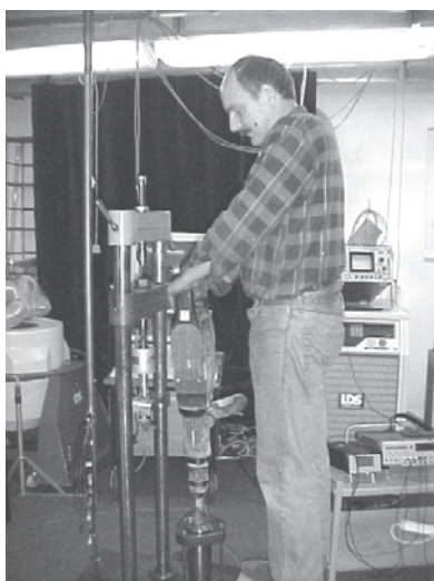
Rys. 6. Diagnostowany system biologiczno-mechaniczny Człowiek – Zmechanizowane Narzędzie Ręczne - młot elektr. H 905; m = 11,3 kg, f_r = 36 Hz)
