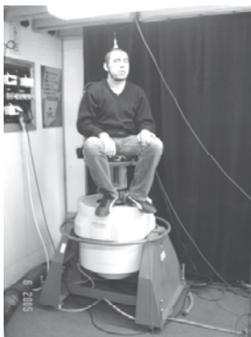
Rys. 3. Stanowisko badawcze do badań drgań ogólnych człowieka-operatora maszyn i pojazdów w pozycji siedzącej
