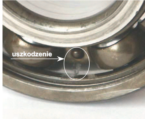
Rys. 11. Uszkodzenie bieżni zewnętrznej łożyska tocznego
