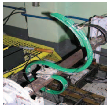
Rys. 7. Sprężyna na stanowisku badawczym
