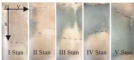
Rys. 3. Przyjęta klasyfikacja stopnia przegrzania łopatek (wg dotychczas stosowanej oceny) – pozyskanie obrazów za pomocą aparatu cyfrowego
