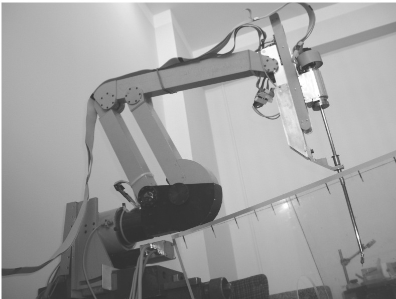
Rys. 1. Prototyp konstrukcji polskiego robota kardiologicznego „RobIn Heart 3” na stanowisku testowym
