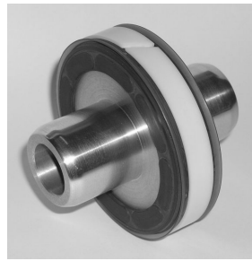
Rys. 7. Zespół tłoka siłownika pneumatycznego: a) części składowe, b) kompletny tłok
