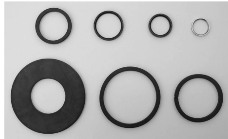
Rys. 4. Kształt i biegunowość magnesów umieszczonych w siłownikach
