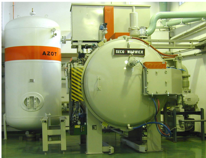
Rys. 3. Piec próżniowy 10.0 VPT-4035/36IQ/K firmy Seco/Warwick przystosowany do realizacji procesów nawęglania próżniowego
