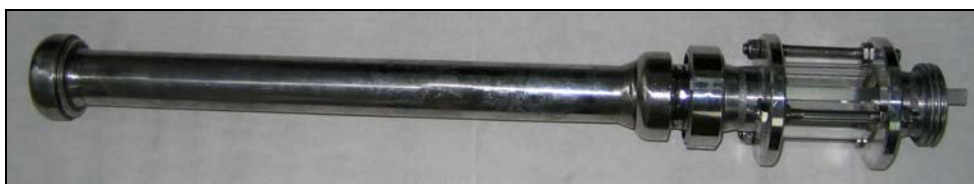
Rys. 4. Brudzony odcinek rurociągu z elementem kontrolnym Fig. 4. Soiled pipeline section with control element
