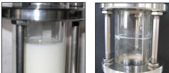
Rys. 6. Element kontrolny zalany mlekiem i ze śladami zabrudzenia
