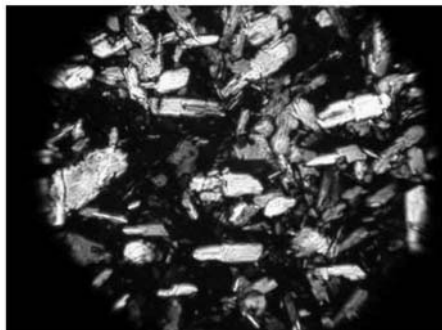
Rys. 4. Pozostałości krystaliczne w upłynnionym miodzie w T=60°C
