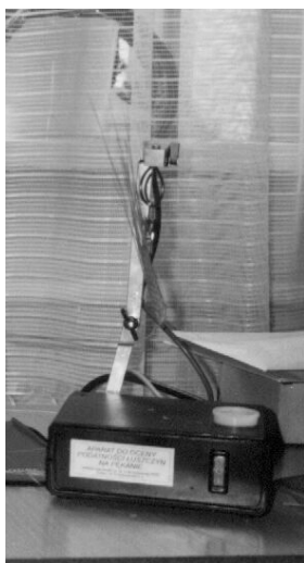
Rys. 1. Aparat do mierzenia siły związania ziarniaków z kłosem
