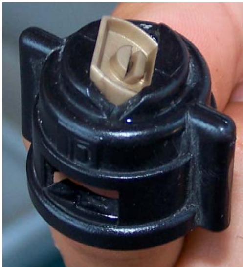
Rys. 1. Widok rozpylacza SPN osadzonego w kołpaku Fig. 1. View of the SPN atomizer seated in a cap
