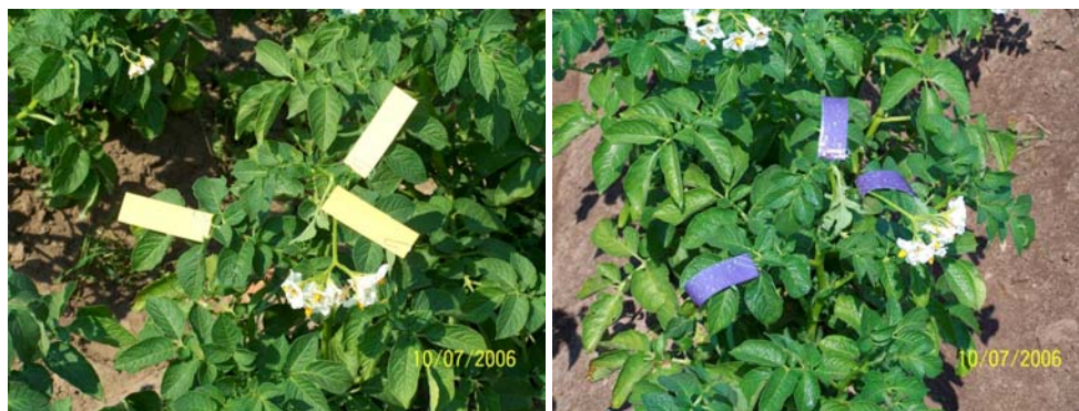
Rys. 1. Widok papierków wodnoczułych rozmieszczonych na wyższym poziomie: przed - i po naniesieniu cieczy
