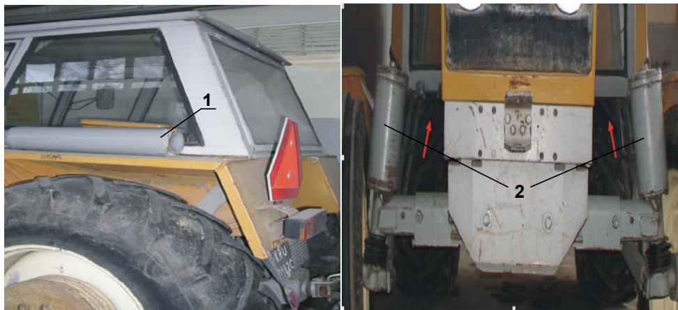
Rys. 3. Przykłady zainstalowania butli gazowych CNG na ciągniku C385: 1 - butle mocowane do nadkoli tylnych po wzmocnieniu konstrukcji błotnika, 2 - butle wzmocnione w części czołowej dolnej strefy kabiny ciągnika
