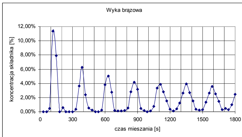
Rys. 1. Wykres zmian procentowego udziału wyki brązowej w mieszance BP Ekonomiczna w czasie 30 minut mieszania Fig. 1. Diagram showing changes in brown vetch percent share in the BP Ekonomiczna mixture over 30 minutes of mixing
