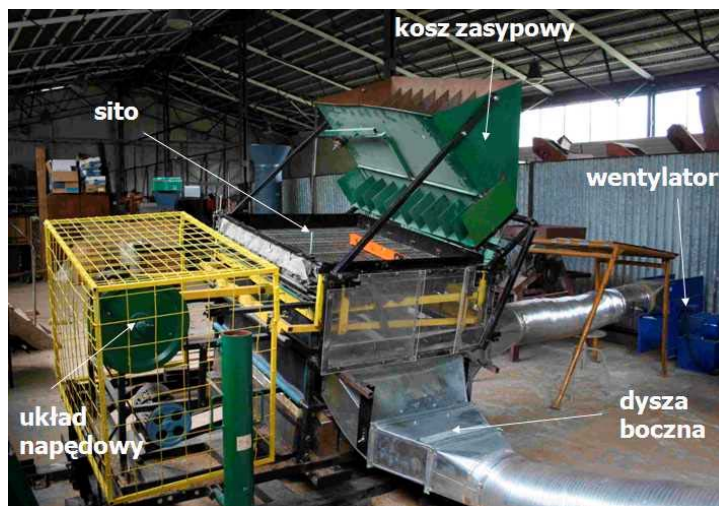
Rys. 1. Widok stanowiska badawczego z zespołem wielokierunkowego strumienia powietrza Fig. 1. View of a testing station with a multidirectional air stream unit
