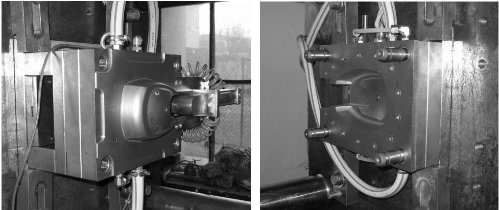
Rys. 7. Forma wtryskowa podczas eksploatacji (podłączony tradycyjny układ chłodzenia)
