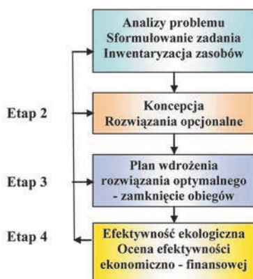
Rys. 5. Schemat postępowania w zakresie optymalizacji i integracji przemysłowych systemów wodno–ściekowych
