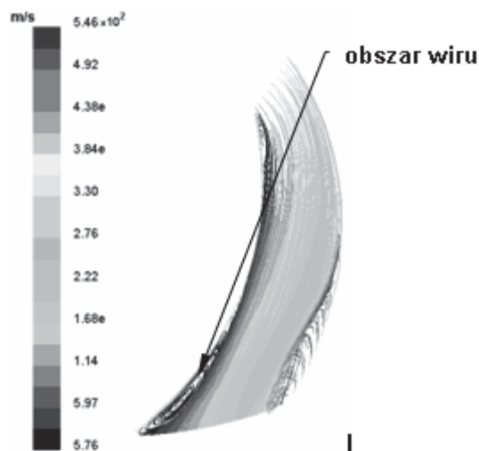
Rys. 6. Przebieg linii prądu w kanale między-łopatkowym wirnika
