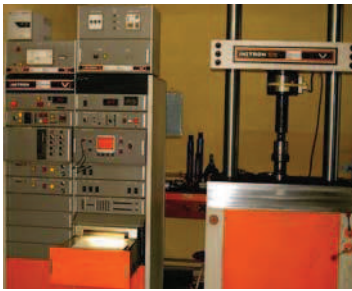
Rys. 1. Maszyna wytrzymałościowa statyczno – dynamiczna typu Instron 1273
