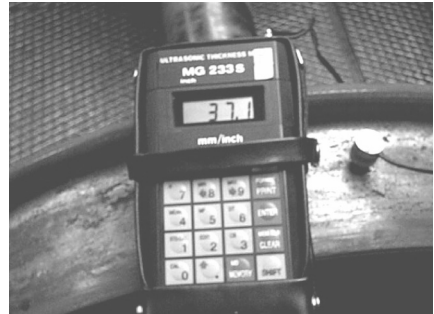
Rys. 3. Sprawdzian do profilu obrzeża obręczy (a) i grubościomierz ultradźwiękowy (b)
