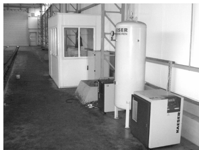
Rys. 9. Stanowisko do badania układów hamulcowych pojazdów szynowych
