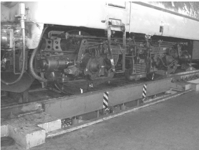
Rys. 8. Widok lokomotywy na stanowisku do badania nacisków kół (a) i wzorcowy wykres [6] badania jednego zestawu kołowego (b)
