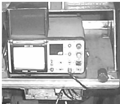
Rys. 4. Stanowisko do defektoskopii ultradźwiękowej
