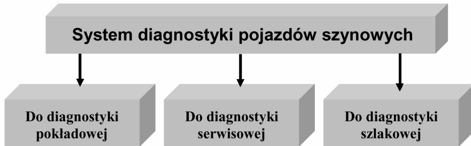
Rys. 1. Podział urządzeń systemu diagnostyki technicznej pojazdów szynowych ze względu na ich usytuowanie
