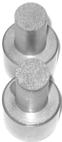
Rys. 3. Przykład kohezyjnego zniszczenia połączenia klejowego
