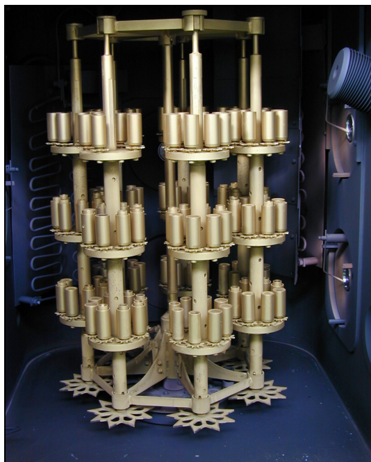
Rys. 2. Planetarny system lokalizacji podłogi (przykładowa konfiguracja)
