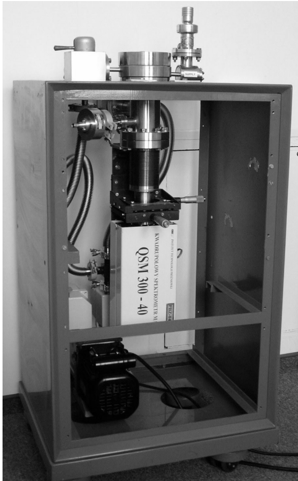
Rys. 3. Zdjęcie laboratoryjnego zestawu spektrometru mas wyładowania jarzeniowego
