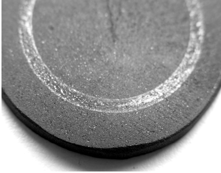
Rys. 1. Powierzchnia tarczy z kompozytu z naniesionym podczas tarcia brązem
