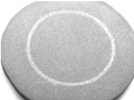
Rys. 3. Powierzchnia tarczy z kompozytu po współpracy z żeliwem
