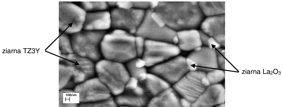
Rys. 6. Przykładowa mikrostruktura spieku TZ3Y-20%mol.La 2 O 3
