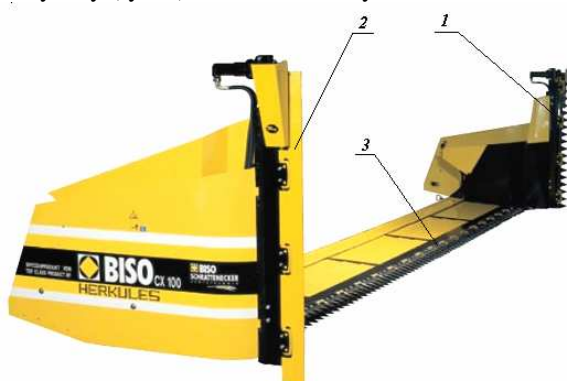
Rys. 6. Widok aktywnego rozdzielacza ładu z napędem hydrostatycznym, prod. BISO Austria: 1 – listwa tnąca rozdzielacza, 2 – osłona listwy, 3 – zespół tnący z wydłużonym stołem (www.biso-austria.com)
