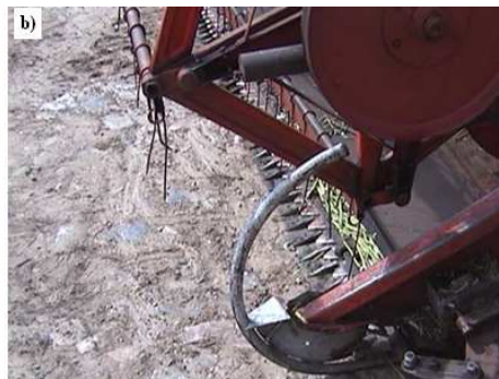
Rys. 5. Bierne rozdzielacze ładu: a) klasyczny skrzydłowy, b) zmodyfikowany o kształcie kołowym (fot. W. Żak) Fig. 5. Passive canopy divider: a) with classical wings, b) modernized in circular shape (photo W. Żak)
