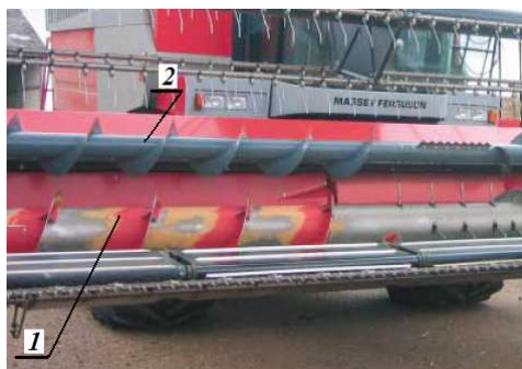
Rys. 7. Widok zmodernizowanego zespołu żniwnego kombajnu Massey-Fergusson, przystosowanego do zbioru rzepaku: 1 – przenośnik ślimakowo-palcowy, 2 – podajnik ślimakowy (www.masseyferuson.com.)
