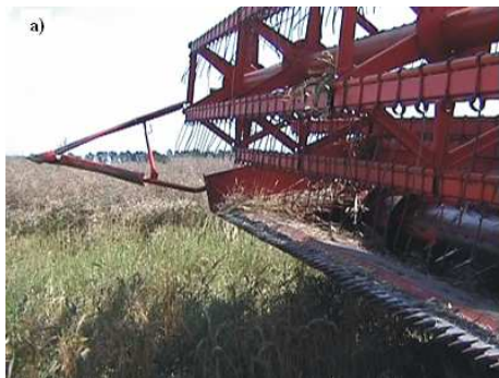
Rys. 5. Bierne rozdzielacze ładu: a) klasyczny skrzydłowy, b) zmodyfikowany o kształcie kołowym (fot. W. Żak) Fig. 5. Passive canopy divider: a) with classical wings, b) modernized in circular shape (photo W. Żak)
