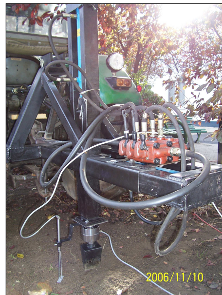
Rys. 1. Stanowisko w pełni oprzyrządowane i przygotowane do wykonywania prób penetracji
