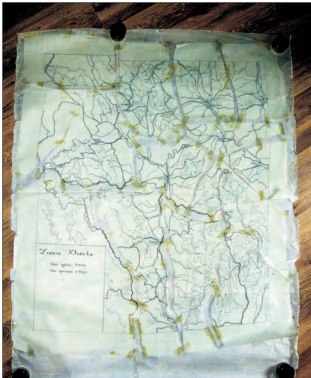
Ryc. 5. Montaż fragmentów porozcinanego rysunku podstawowych elementów treści mapy turystycznej Ziemi Kłodzkiej w skali 1:90 000, przygotowanego na podstawie kartometrycznych materiałów źródłowych Fig. 5. Assembly of parts of a cut drawing of basic elements of Ziemia Kłodzka tourist map at 1:90 000 prepared basing on cartometric source materials
