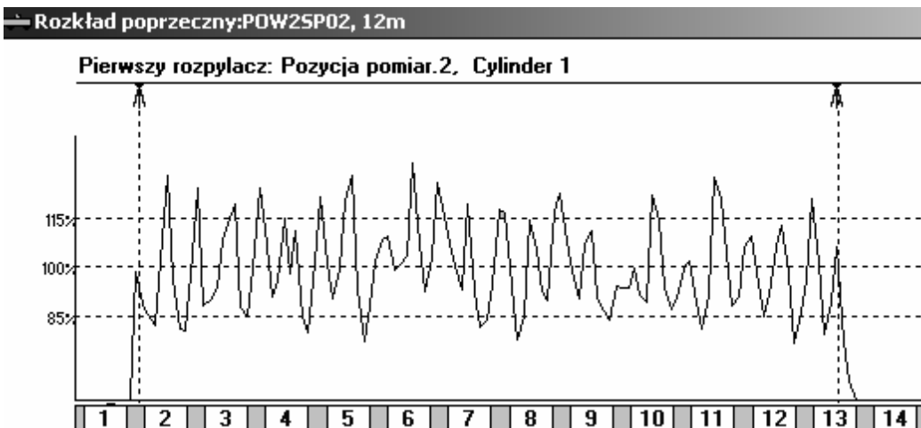
Rys. 2. Rozkład poprzeczny cieczy dla belki polowej z zamontowanymi rozpylaczami 110-SF-02
