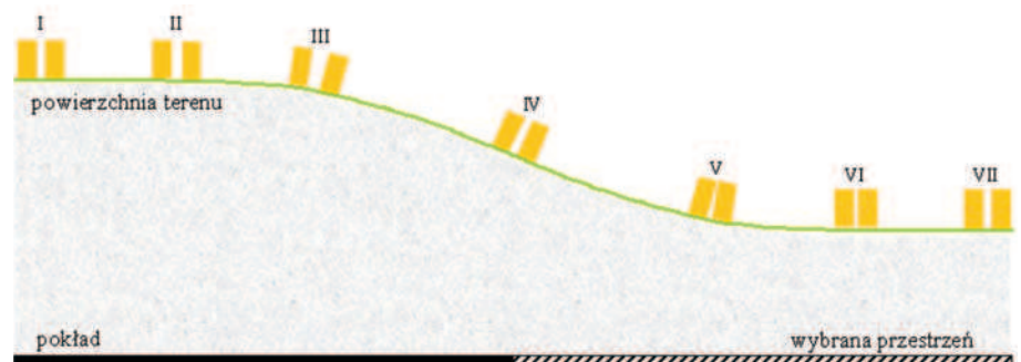
Rys. 9. Wpływ eksploatacji na budynki w zależności od ich położenia względem krawędzi eksploatacji
