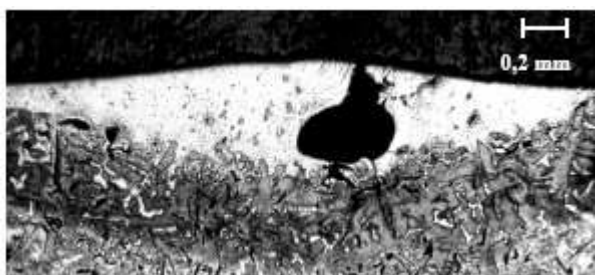
Rys. 5. Pęknięcie połączone z obszarem przypominającym pęcherz lub por widoczne w strukturze żeliwa stopowego po obróbce laserowej (moc wiązki lasera P = 1884 [W], prędkość wiązki względem próbki v = 10,7 [mm/s] i średnica wiązki lasera d = 4 [mm])
