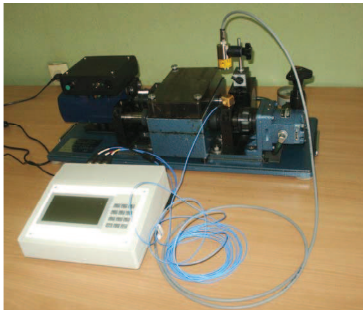
Rys. 2. Programowalne Urządzenie Diagnostyczne na stanowisku badawczym przekładni demonstracyjnej DMG-1M
