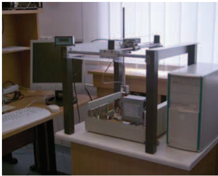
Rys. 2. Stanowisko pomiarowe do bezkontaktowego, przestrzennego badania rozkładu temperatury w urządzeniach elektronicznych
