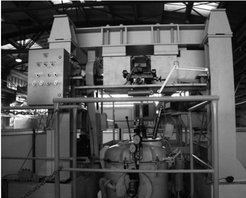
Rys. 2. Zdjęcia doświadczonego urządzenia do odlewania taśm amorficznych (widok ogólny oraz bębny odlewniczy)
