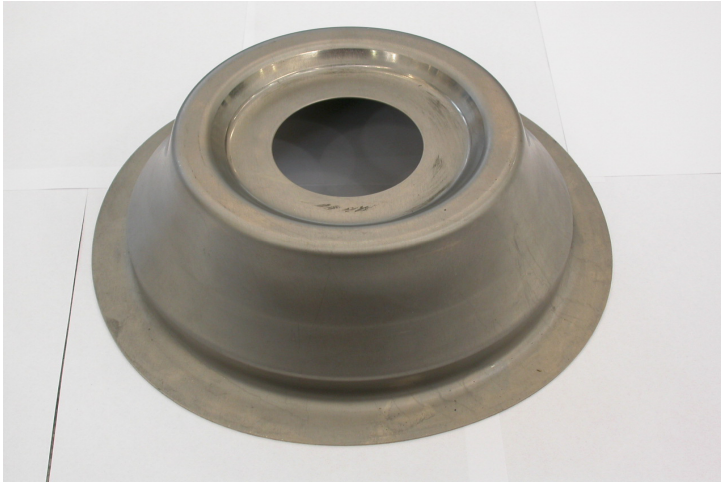
Rys. 6. Kanał wewnętrzny elementu silnika samolotowego
