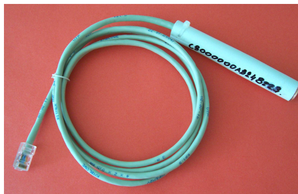
Rys. 5. Obudowa zewnętrzna DS18B20 Fig. 5. DS18B20 outside casing
