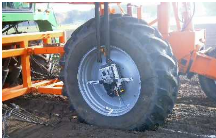
Rys. 4. Widok jednostki napędowej wraz z urządzeniem pomiarowym [Jakliński 2004] Fig. 4. View of a driving unit with measuring apparatus
