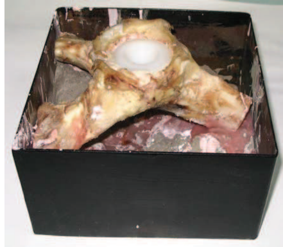
Rys. 3. Widok fragmentu kości stawu zwierzęcego z zacementowaną panewką polietylenową
