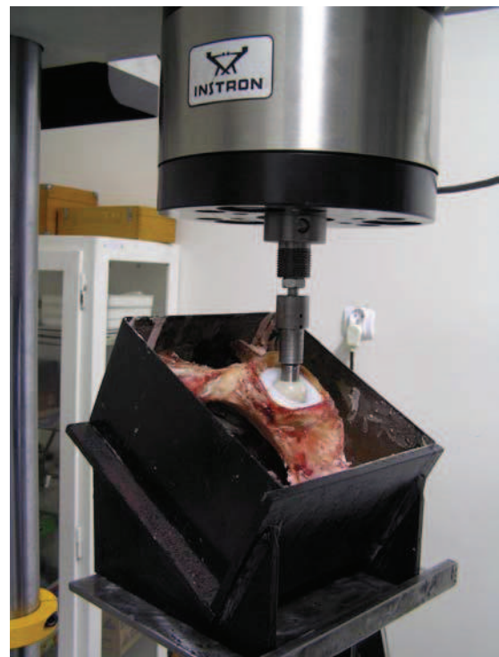
Rys. 4. Widok modelu z zacementowaną panewką polietylenową poddawaną cyklicznemu obciążaniu pod kątem 30^{\circ} względem normalnej do równika panewki
