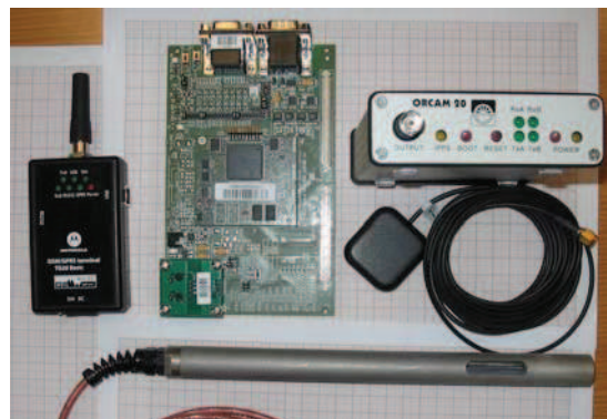
Rys. 5. Elementy składowe wersji laboratoryjnej stanowiska pomiarowego z mikrokomputerem phyCORE
