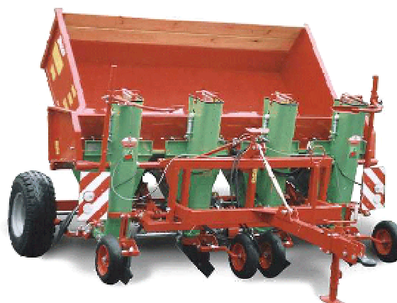
Rys. 9. Sazdarka Kora 4HP firmy FMR AGROMET Spółka z o.o. – automatyczna, przyczepiana, czterorzędowa, taśmowo-czerpakowa; ładowność zbiornika 2000 kg, rozstaw rzędów 75 cm
