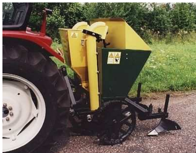
Rys. 4. Sadzarki serii S-208 firmy POL-MOT TUR SA. - automatyczne, zawieszane, dwurzędowe, łańcuchowo-czerpakowe; ładowność zbiornika 250 lub 410 kg, rozstaw rzędów 62,5; 67,5 cm
