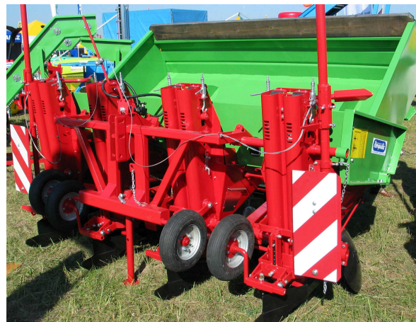
Rys. 7. Sazdarka S-211/1 Super firmy REMPRODEX Spółka z o.o. – automatyczna, zawieszana, czterorzędowa, taśmowo-czerpakowa; ładowność zbiornika 1000 kg, rozstaw rzędów 75 lub 90 cm
