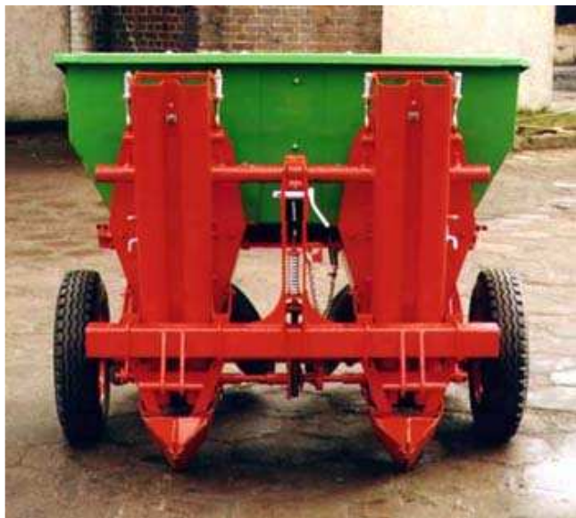
Rys. 5. Sazdarka S-211 firmy REMPRODEX Spółka z o.o. - automatyczna, zawieszana, dwurzędowa, taśmowo-czerpakowa; ładowność zbiornika 300 kg, rozstaw rzędów 62,5-75,0 lub 75-90 cm
