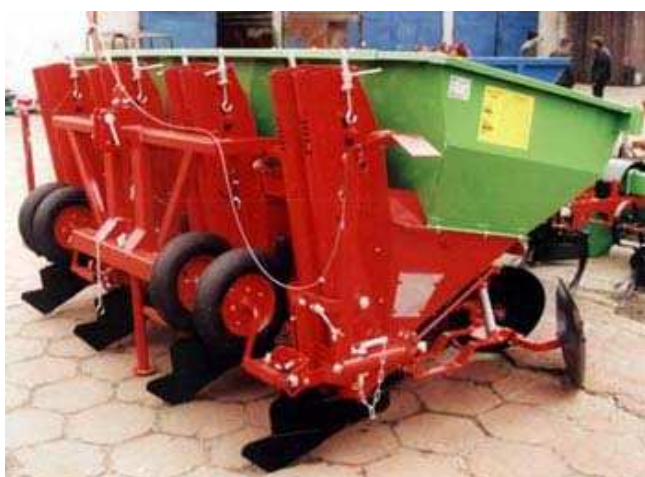
Rys. 6. Sazdarka S-211/1 firmy REMPRODEX Spółka z o.o. – automatyczna, zawieszana, czterorzędowa, taśmowo-czerpakowa; ładowność zbiornika 800 kg, rozstaw rzędów 62,5-75,0 lub 75-90 cm
