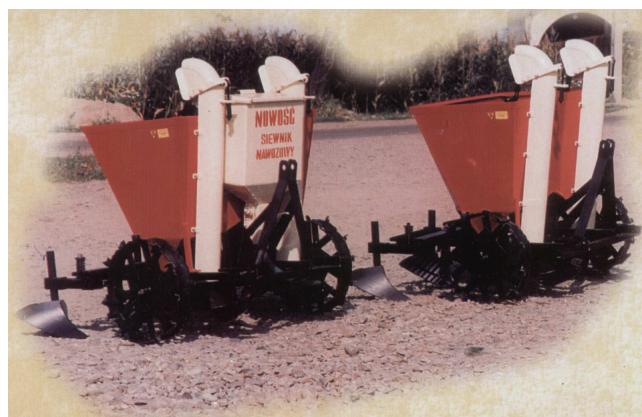
Rys. 3. Sadzarki serii S-227 firmy AKPIL P.P.U.H. - automatyczne, zawieszane, dwurzędowe, łańcuchowo-czerpakowe; ładowność zbiornika 180 lub 300 kg, rozstaw rzędów 62,5; 67,5; 70,0; 75,0 cm
