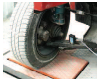
Rys. 14. Sposób mocowania przetwornika pomiarowego na wahaczu
