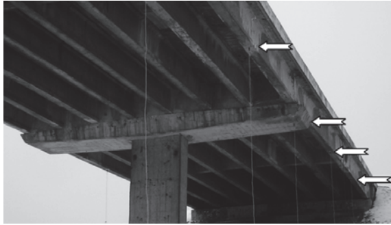
Rys. 3. Czujniki zamocowane na dźwigarze wiaduktu
