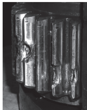
Rys. 1. Widok zniszczonego koła zębatego o efekcie wystąpienia uszkodzenia lokalnego
