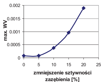
Rys. 2. Zależność wartości maksymalnej rozkładu Wignera-Ville'a ( WV ) sygnału resztkowego od symulowanego pęknięcia podstawy zęba – brak odchyłek wykonania
