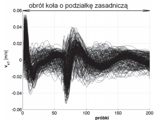
Rys. 4. Nałożenie sygnałów prędkości drgań poprzecznych wału zębata, których czas trwania równy jest obrotowi diagnozowanego koła zębatego o podziałkę zasadniczą – rozpędzanie i sinusoidalnie zmienny moment obciążenia
