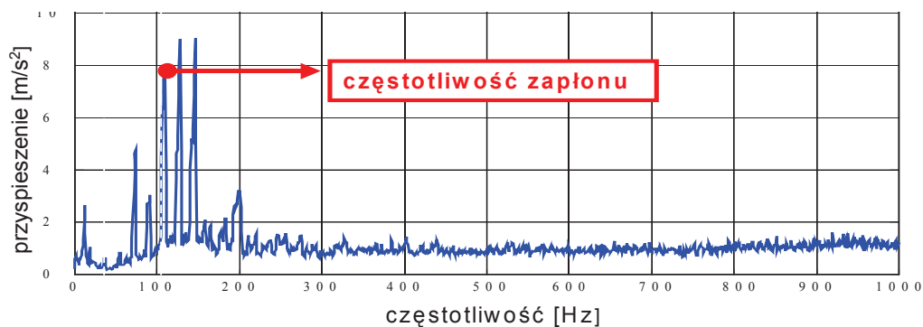
Rys. 5. Widmo drgań dźwigni zmiany biegów
